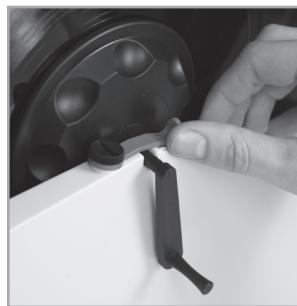
Fixieren Sie die Achse durch Schließen der beiden Achssicherungen.
